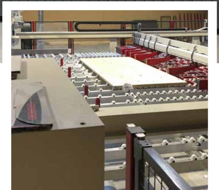
Die neue Plattenaufteilsäge fh4 von IMA Schelling arbeitet mit einer Leistung von 18 KW.
